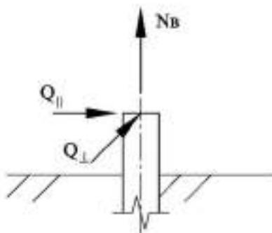
Рис. И.6. Схема приложения нагрузок на фундамент
