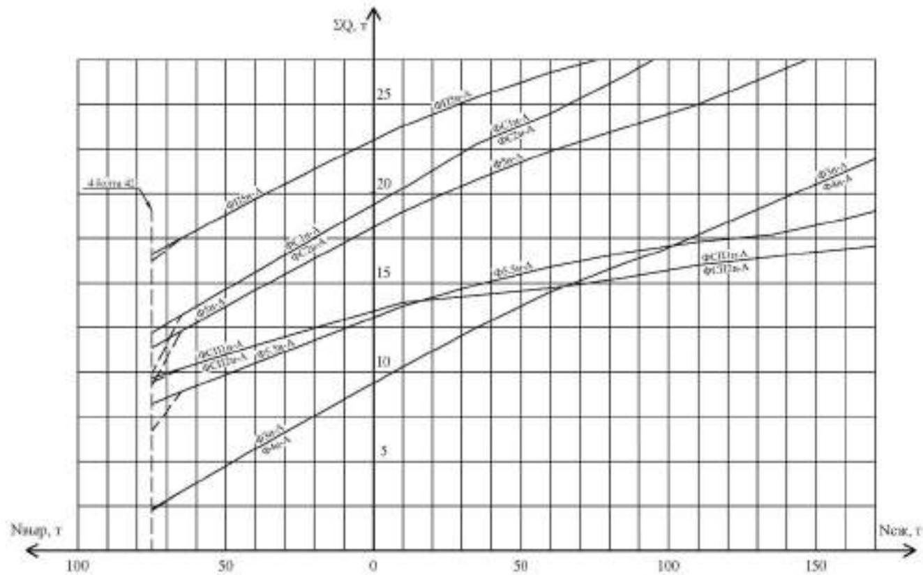
**График Ж.6 – Допускаемые расчетные нагрузки на фундаменты под анкерно-угловые опоры, исходя из несущей способности плит фундаментов**
