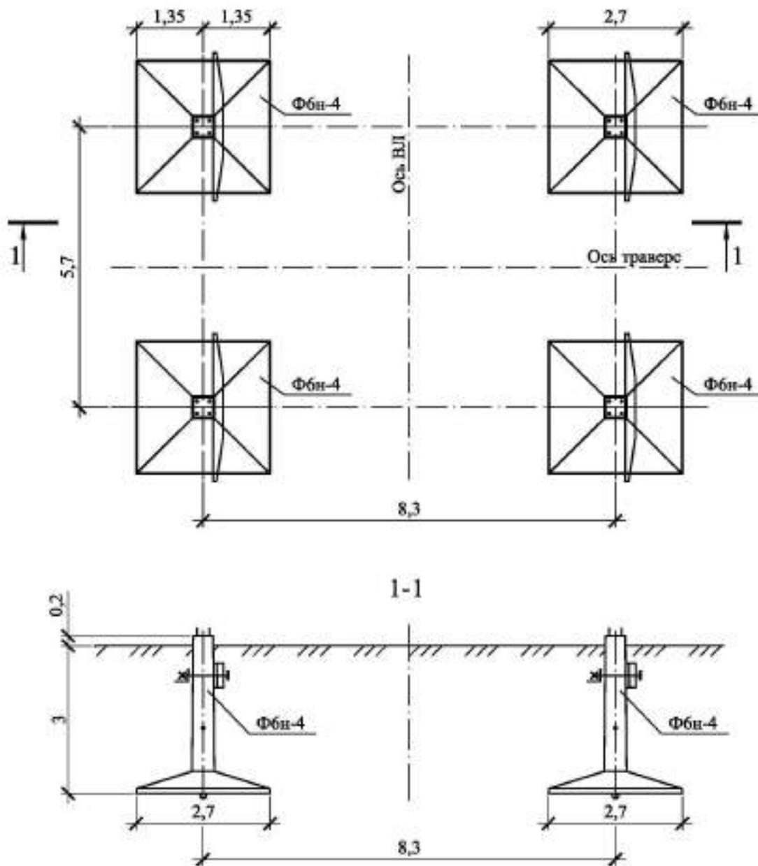
Рис. И.3. Схема расположения фундаментов опоры
