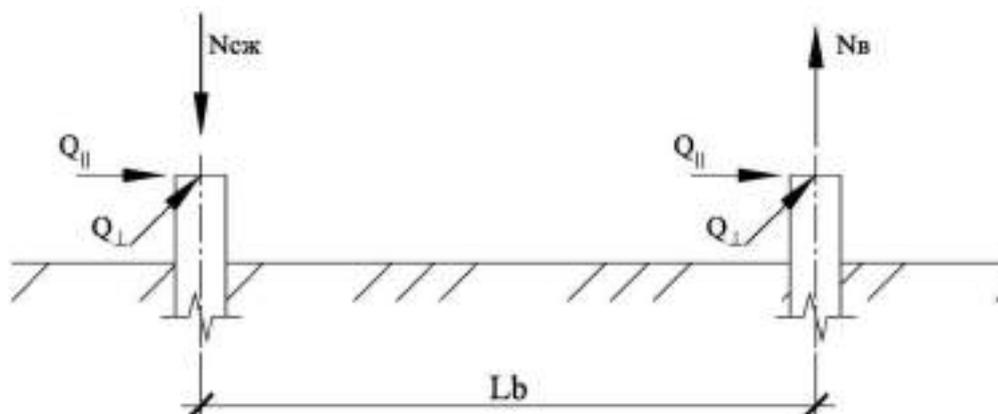
Рис. И.2. Схема приложения нагрузок на фундамент
