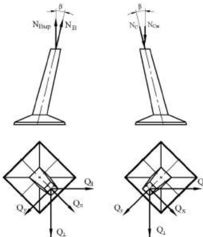
Рис. И.8. Схема приложения нагрузок на фундамент
