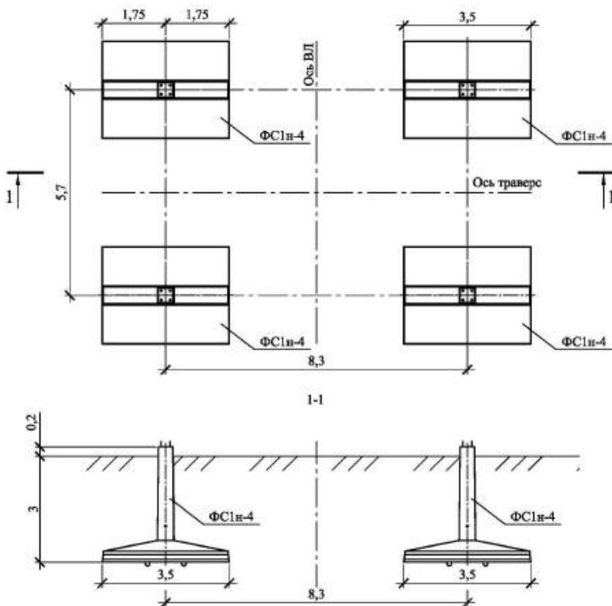
Рис. И.1. Схема расположения фундаментов опоры
