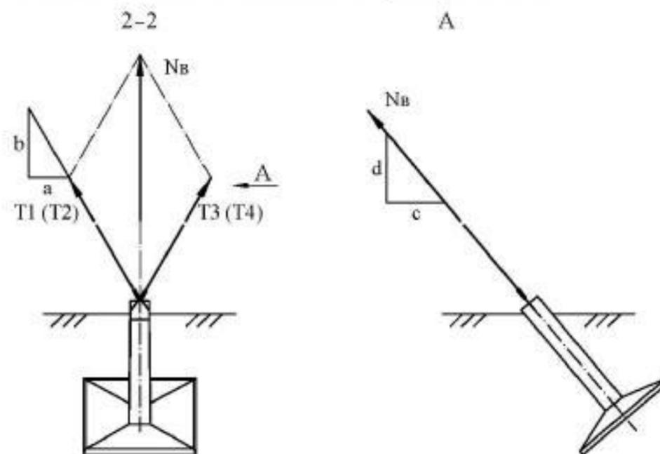
Фундаменты с наклонными стойками.
