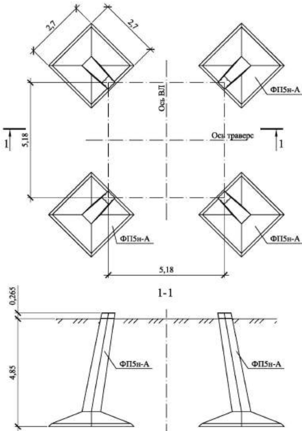
Рис. И.7. Схема расположения фундаментов опоры
