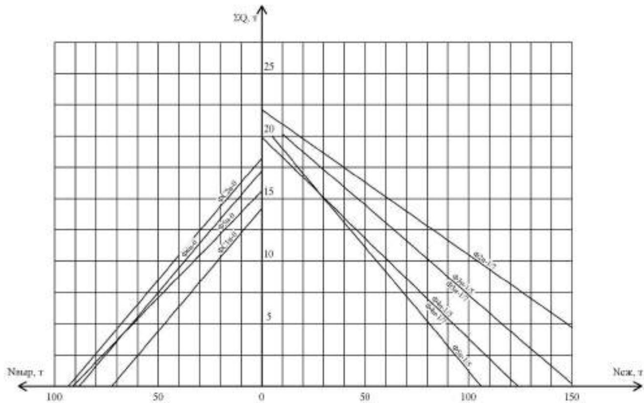
**График Ж.5 – Допускаемые расчетные нагрузки на фундаменты под анкерно-угловые опоры, исходя из несущей способности стоек фундаментов и анкерных болтов**
