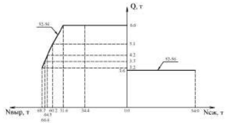
**Графики допустимых расчетных нагрузок, исходя из прочности фундаментов и анкерных болтов**
