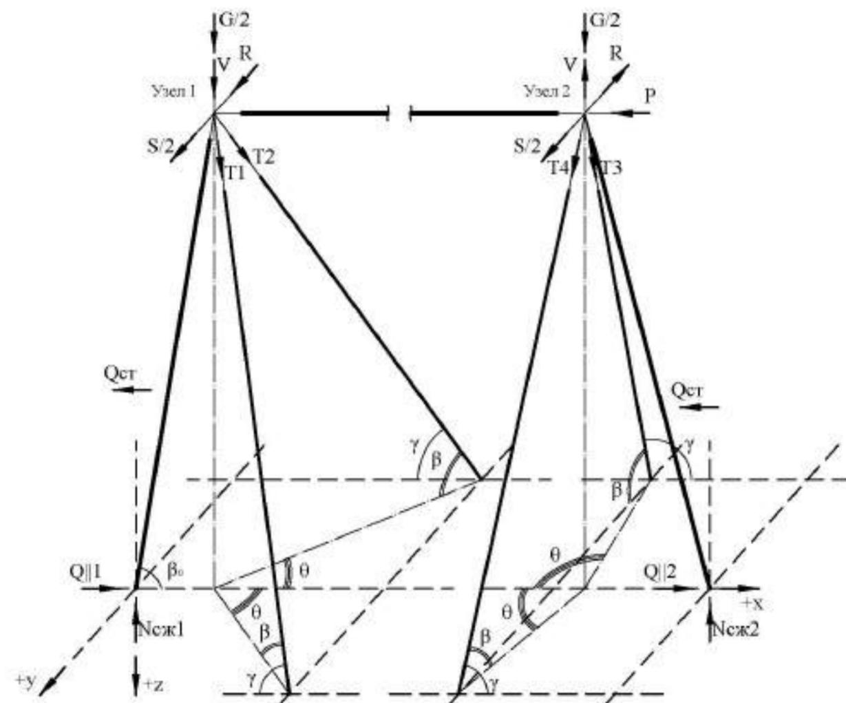
Рис. В.4 Схема нагрузок приведённых к узлам
