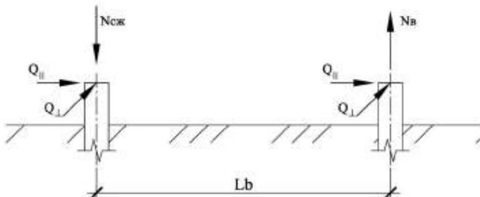
Рис. И.4. Схема приложения нагрузок на фундамент
