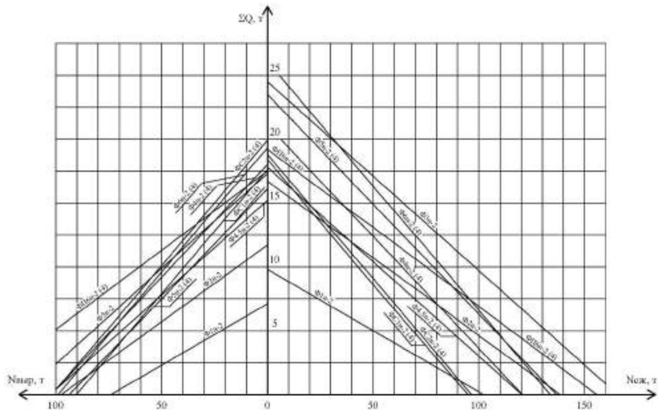
**График Ж.3 – Допускаемые расчетные нагрузки на фундаменты под порталные промежуточные опоры на оттяжках, исходя из несущей способности стоек фундаментов и анкерных болтов**
