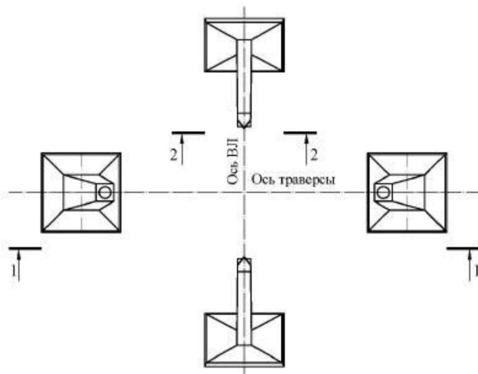
Рис. В.5 План расположения фундаментов порталных опор
