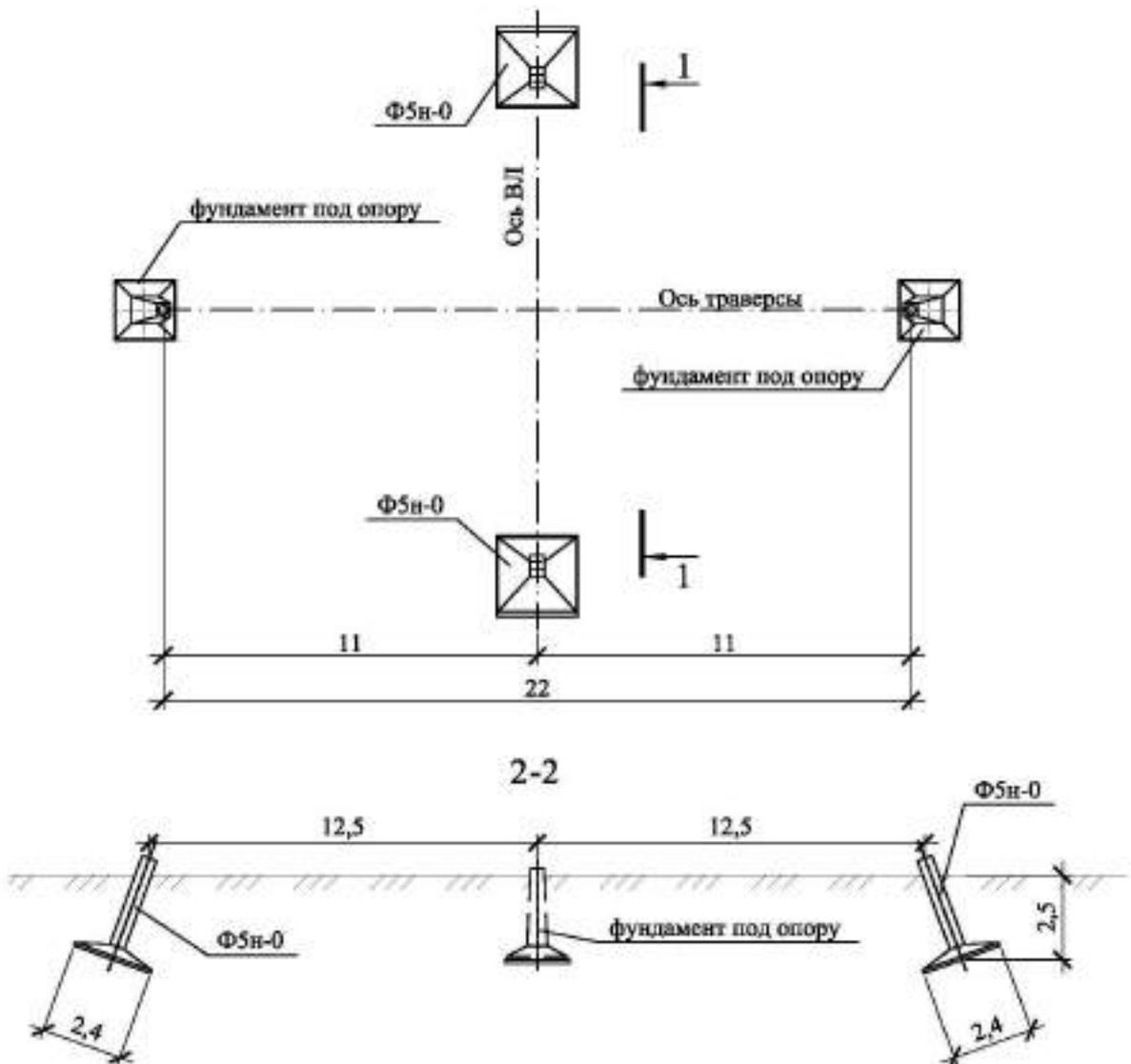
Рис. И.5. Схема расположения фундаментов опоры
